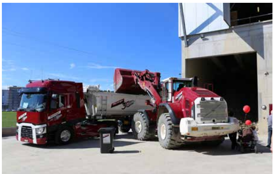
Verlad des Filterschlammkuchens in nutzlastoptimierten Sattelzug LKW
