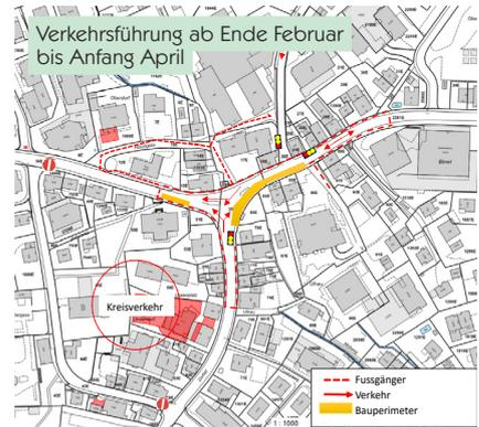
strasse Fahrtrichtung Neuhaus. In diesem Bereich werden für ca. fünf Wochen die Randabschlüsse und Beläge ersetzt. In dieser Zeit verkehren alle Buslinien über die Rössli-gass. Parallel zu den Arbeiten in der Rickenstrasse erfolgt der Einbau der Betonplatte bei der Bushaltestelle Post (Fahrtrichtung Neuhaus).
