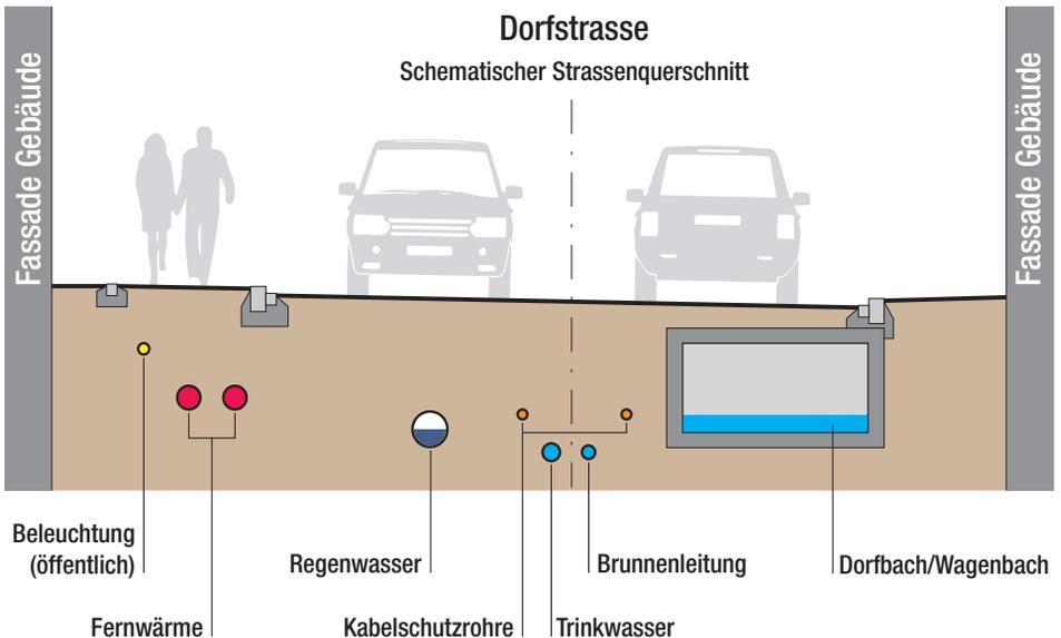
Im Zuge der Strassensanierung und Dorfplatzgestaltung werden die unterirdischen Werkleitungen modernisiert und an die heutigen Bedürfnisse angepasst.
